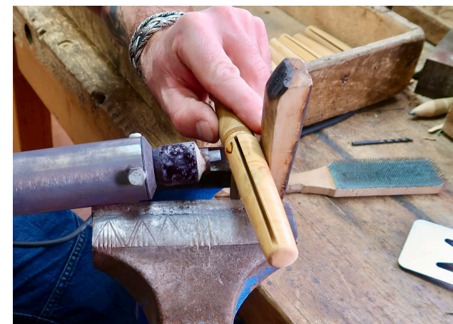
Studio MR, vue d'atelier Coutellerie de Nontron, Petit Duc , 2019. Lame en acier inaltérable T12, manche en buis pyrogravé et virole en laiton © Studio MR
