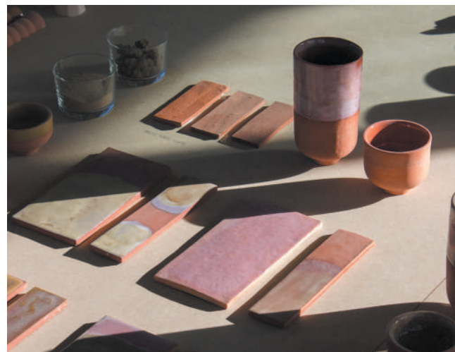
Carreaux et objets réalisés en terres d'excavation du Grand Paris © Lucie Ponard
